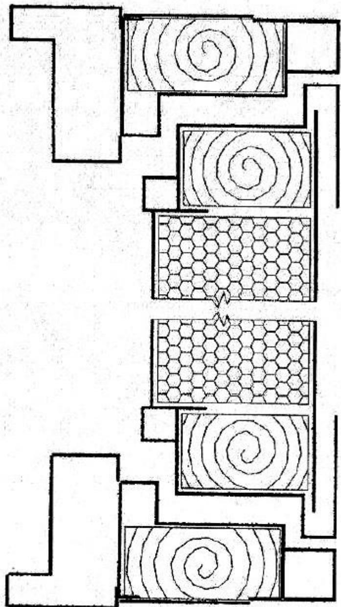
Рисунок 3 — Пример конструкции дверного блока, сваренного на стальных листов и профилей (с заполнением среднего профиля коробки и полотна древесным и пенным материалом).
