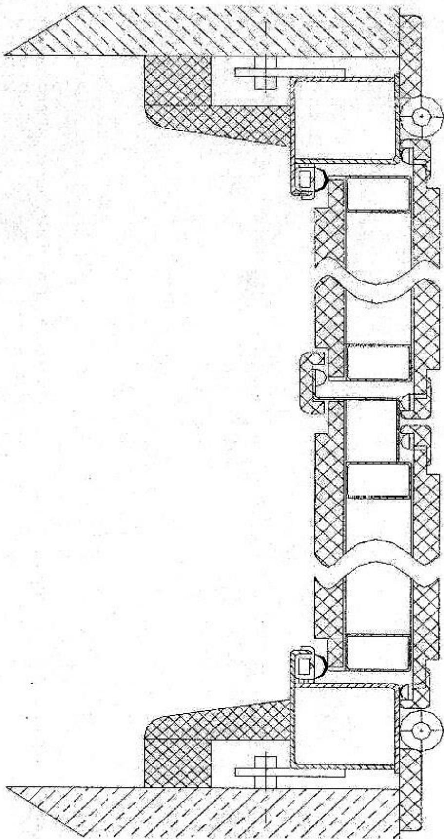
Рисунок 5 — Пример конструкции двупольного дверного блока с облицовкой из древесины или древесно-плиточных материалов (горизонтальное сечение)
