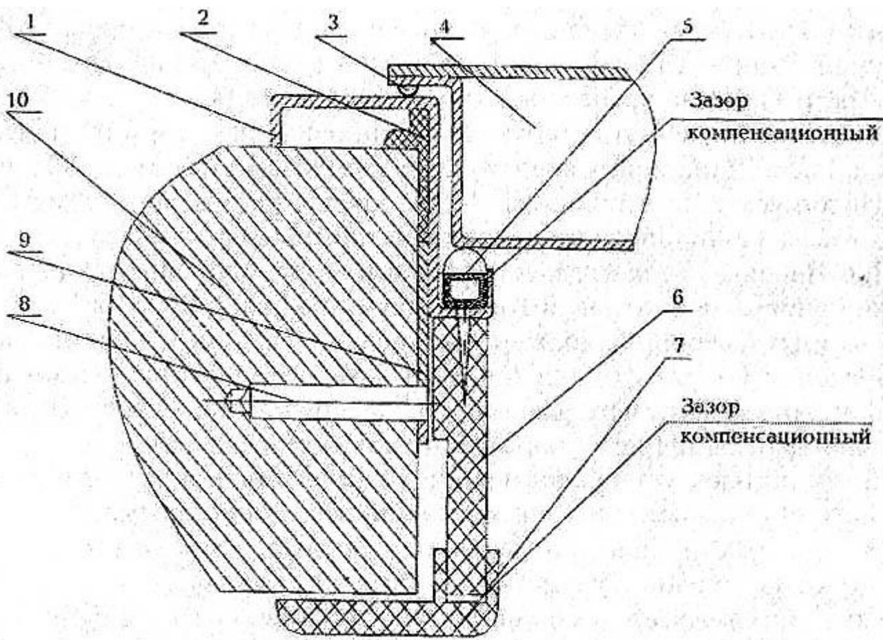
1—коробка (рама) дверного блока; 2—монтажная пена; 3—наружное уплотнение; 4—полотно дверного блока; 5—внутреннее уплотнение; 6—портал декоративного обрамления; 7—наличник; 8—монтажный анкер; 9—монтажное ухо; 10—стена.
