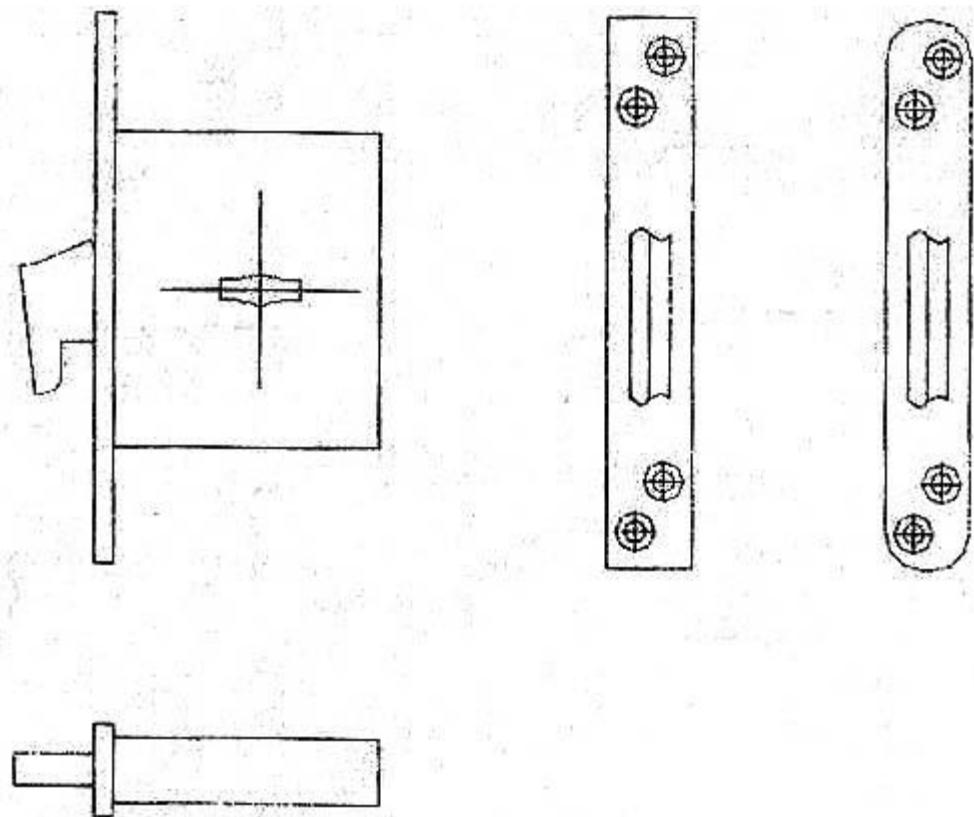
Рисунок Б.4— Пример замка с крюкообразным засовом
