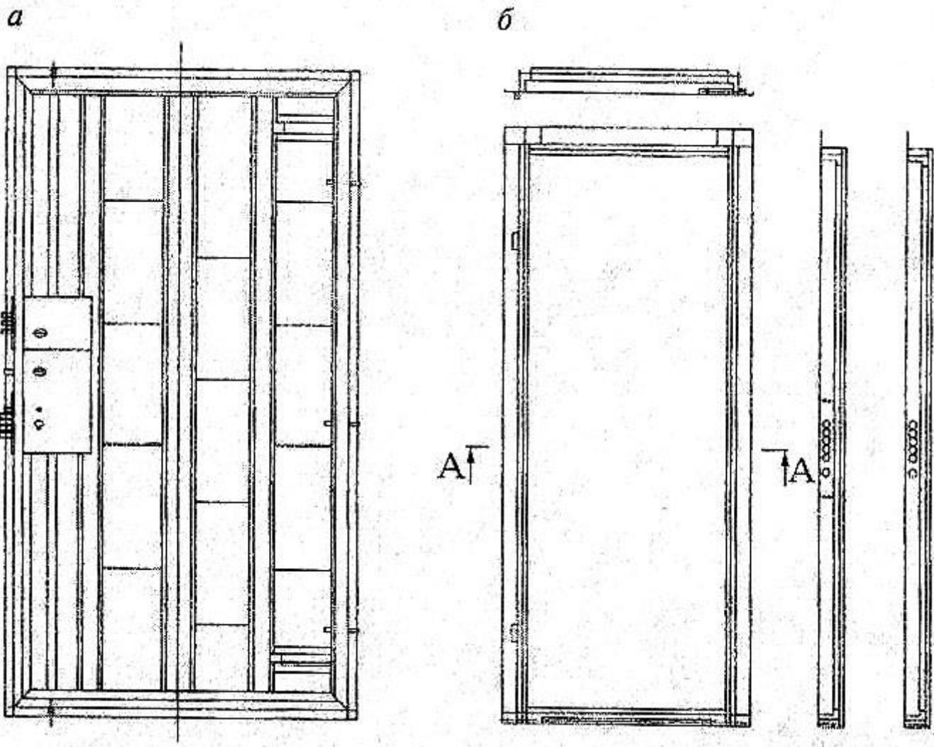
Рисунок 7 — Примеры конструкции дверного полотна, сваренного из стальных профилей, с вертикальными и горизонтальными усиливающими профилями и установленными замками (а) и дверной коробкой (б).
