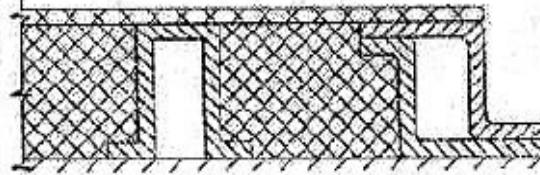
Полотно с наружным стальным листом и внутренним листом из ДВП - с профилями сложного сечения и заполнением из древесного или минерального утеплителя.
